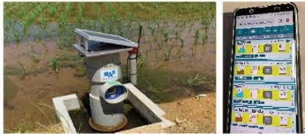
【スマートフォンで遠隔で操作・管理できる多機能型自動給水栓】
