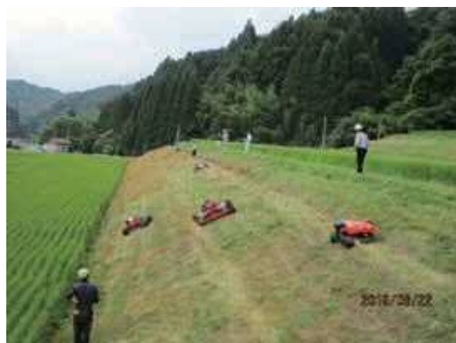
ラジコン草刈り機検証状況
