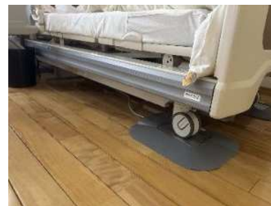
ベッドの脚に設置した荷重センサーが利用者の状態を検知
