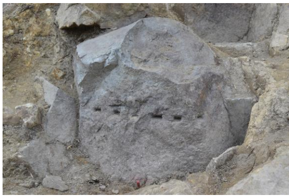
石切り場に残る 工具の痕跡
