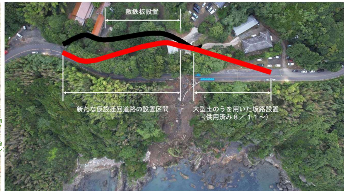
図 観光客等を含む一般車両(大型車両を除く)の通行が可能なルート【片側交互通行】
