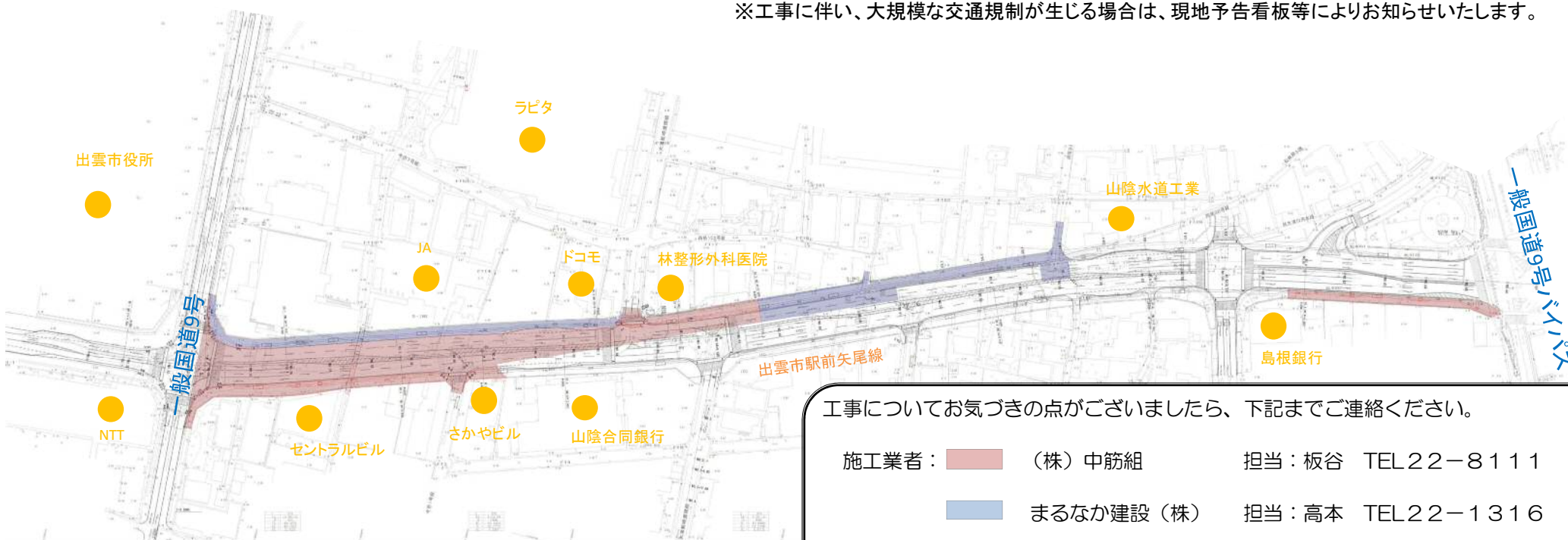
電線共同溝工事、歩道、車道の舗装工事を行います 西側の工事が概ね完了した後、車線を変更し、東側の工事に移ります
