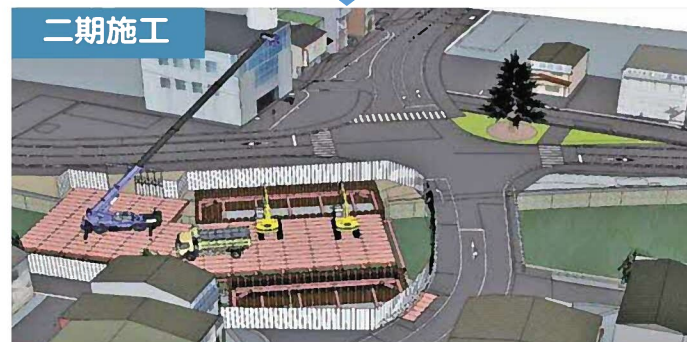
下流側に交通を切り替え、上流側の既設橋梁を撤去し、新しい橋を設置します。
