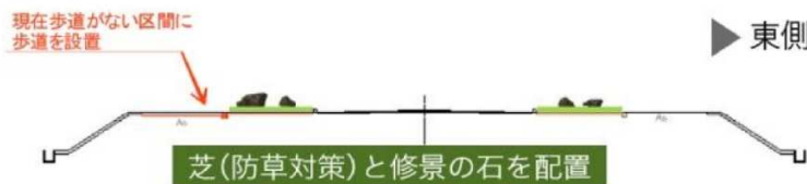
出雲空港穴道線 計画断面図
