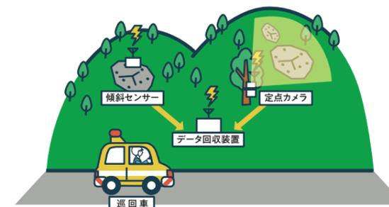
落石源にセンサーを取り付け、さらに定点カメラを設置し、石の挙動データを収集→回収する手法を検討しています。実現すれば、点検の省力化や定量的な診断等の効果が期待されます。
