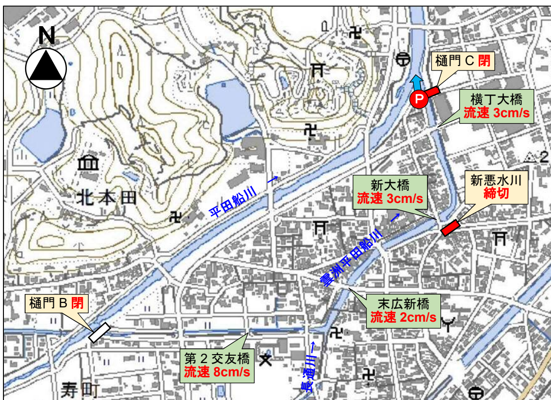
図-3.3.12 ポンプ稼働試験概要（第2段階）
