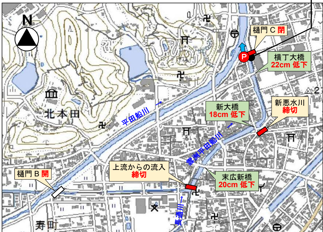
図-3.3.11 ポンプ稼働試験概要（第1段階）
