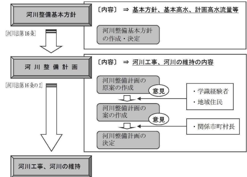
図 1-2 河川整備基本方針～整備計画～工事実施までの流れ
