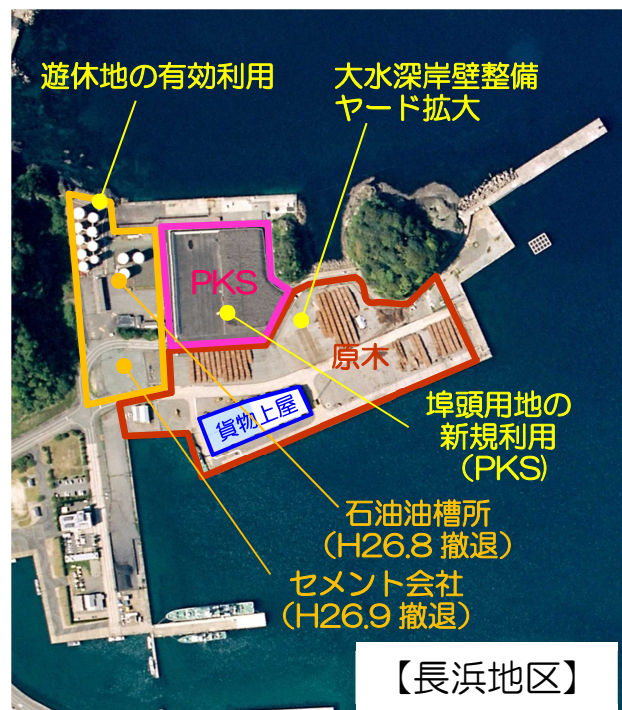
図 2-7 ヤードの利用状況と活用方法（長浜地区）
