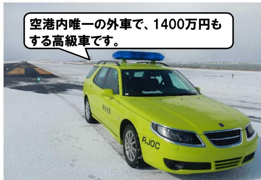
除雪後はこのサーフィス・フリクション・テスター(SFT)車という専用車両で滑走路等を走行し、路面摩擦係数や積雪深・雪質などを調査します。
