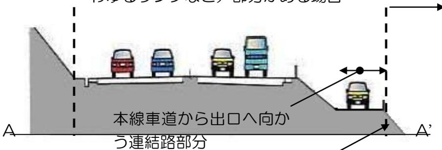
連結路の平坦部の端部（点線部）を基準に外側に向かって 500 メートルを計測。
