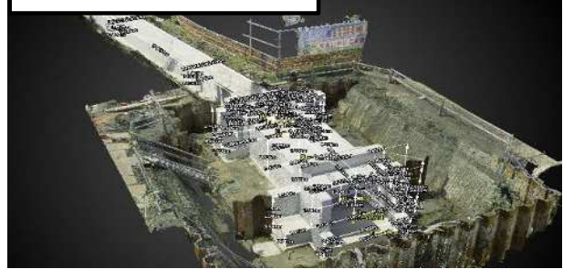
▲ 樋門本体工、川裏水路工における3次元出来形管理の試行【従来管理と比較】
