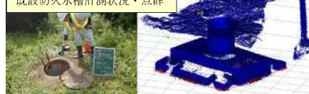
既設防火水槽計測状況・点群
