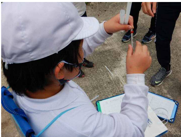
児童4人は、水を汲み、気温(21°C)、水温(15°C)を計測し、CODパケットテストを実施(0)
