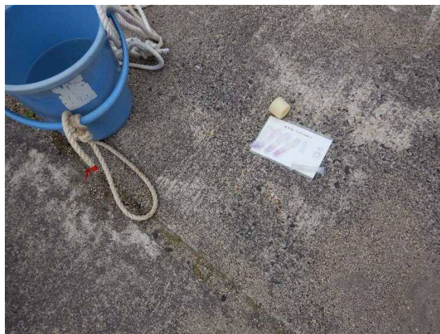
児童4人は、水を汲み、気温(21°C)、水温(15°C)を計測し、CODパケットテストを実施(0)
