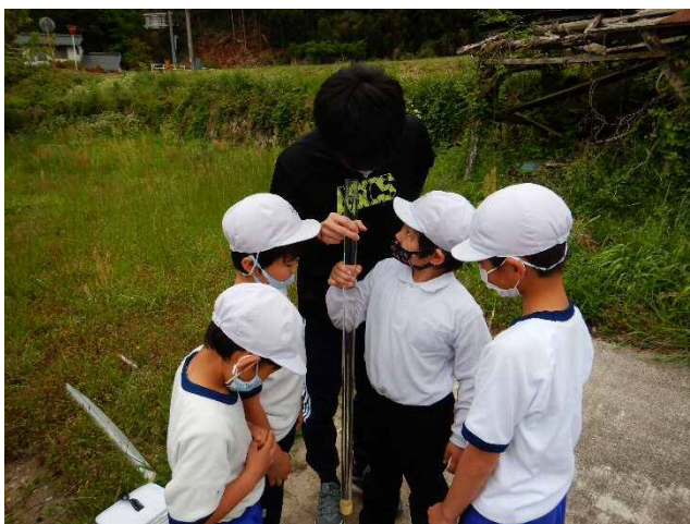
深野川の透視度は、満杯水を入れても十字板の2重線がくっきり見え、昨年同様、最大の102センチを記録。
