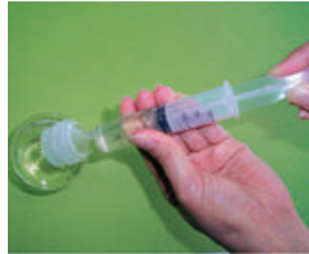
注射器にとった水をろ過しているところ
