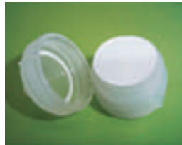
フィルターホルダーにフィルターを置いて、ふたを閉める
