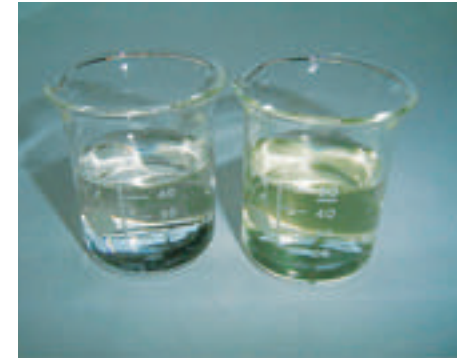
ろ過する前の水(右)とろ過した後の水(左)
