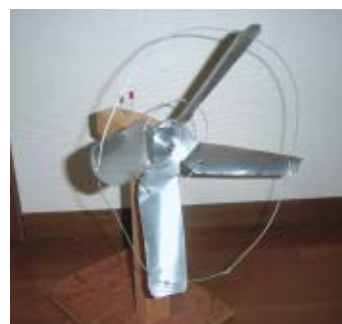
アルミ缶を使って手作り風力発電機を作る
