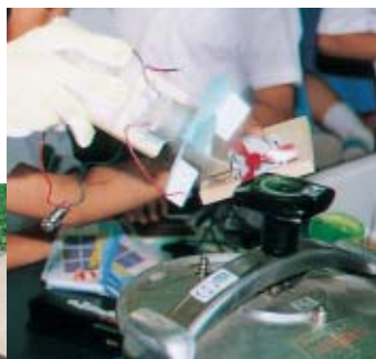
手で太陽電池用モーターを回し、発光ダイオードを照らす
