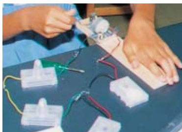
手で太陽電池用モーターを回し、発光ダイオードを照らす
