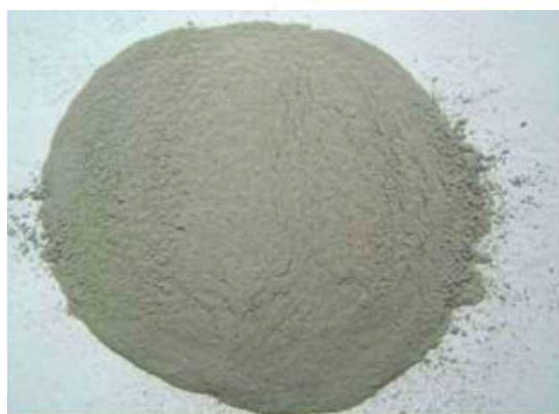
燃焼ボイラ内の高温の燃焼ガス中を浮遊する石炭灰を電気集じん機で集めたもの
