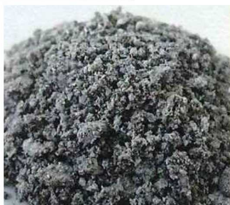
燃焼ボイラ内の高温の石炭灰が溶けて凝集し、ボイラ底部の水槽に落下し堆積したもの
