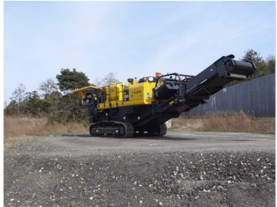
がれき類の破砕施設
