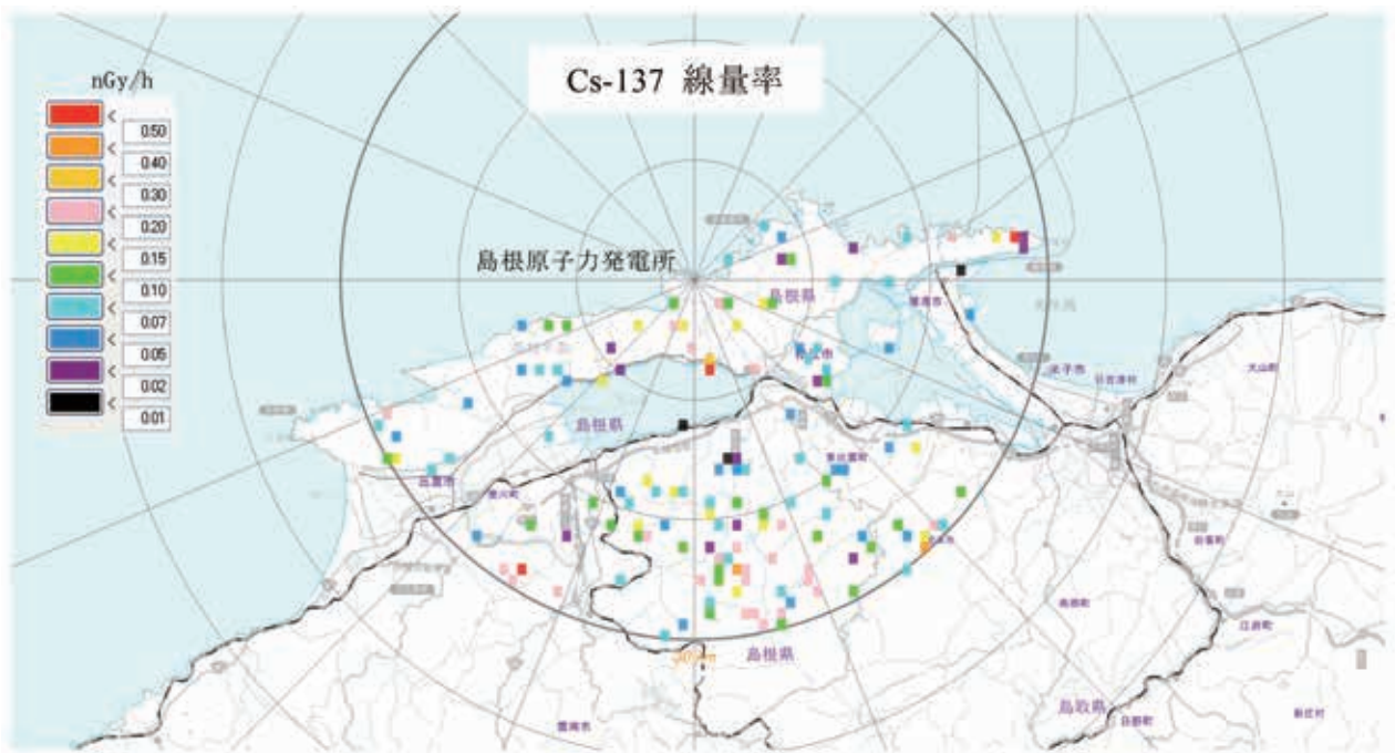
Fig.5 島根原子力発電所 UPZ 内の Cs-137 線量率 (Ge 検出器によるカーボン、40 秒メッシュ)
