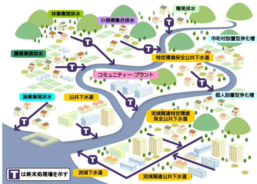
図 2.4 汚水処理施設の概念図
