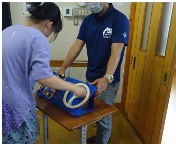
電磁誘導発電を手回しで体験
