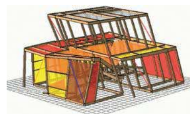
実際の解析例：色が黄色→橙色→赤色と変化し倒壊するのが分かります
