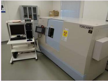
機械金属製品から電子機器、半導体部品まで、小型の製品であれば、ほとんど全ての物を $\mu\text{m}$ 単位の空間分解能で内部の検査や解析を非破壊で行うことが可能な装置です。
