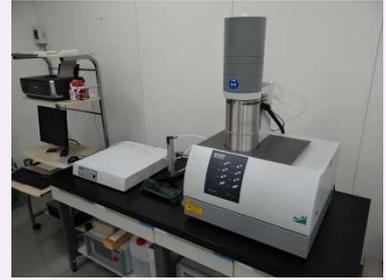
熱拡散率を測定する装置です。比熱は、DSC等で予測しておくことが望ましいですが、比較法により測定することも可能です。熱伝導率は、密度、比熱、熱拡散率の積から求め出します。
