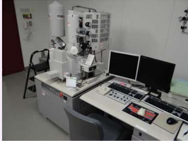
様々な材料の表面を数十万倍の超高倍率、超高分解能で観察できる「電界放射型電子顕微鏡」です。
