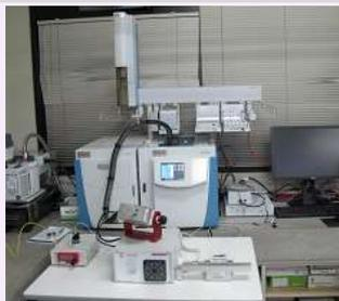
通常的气体クロマトグラフ(分離して質量分析を行う装置)に人間の鼻でにおいを検出して成分を同定する装置です。
