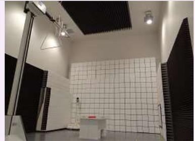
18GHzまでSVSWRでの性能を確認しています。また、プロジェクタがあり、対策効果が暗室内で検証可能です。エア、水道を用意し、様々な計測対象を実動時と同じ状態で評価できます。
