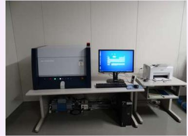
試料にX線を照射することで発生した蛍光X線のエネルギーおよび強度から、物質の成分元素および構成比率を分析する装置です。メッキ膜厚測定、定量分析、RoHS分析が可能な装置です。
