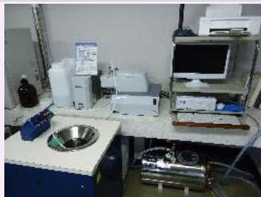
試料(粘土や砂)を水に拡散させ、レーザーを照射して粒度を測定する装置です。
