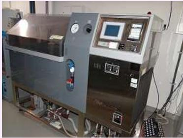
塩水噴霧試験、キャス試験、サイクル試験などの腐食促進試験や耐食性試験をする装置で、塩水等溶液の噴霧や乾燥、潤潤などの各種試験条件を、組み合わせて設定することができます。
