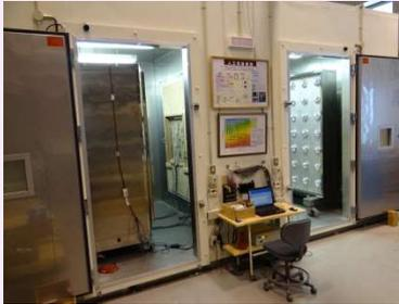
2つの部屋を持つこの装置は、住宅内外の温度、湿度、風速や日射条件を再現することができます。住宅壁材やサッシなどの残熱性、結露状態、変形などを調べることができます。
