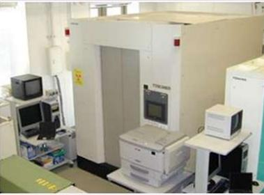
鋳物等の被検体へX線を照射してCTスキャンし、高速で断層像を作成、表示する装置です。
