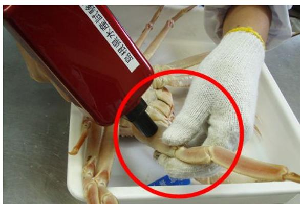
写真2 近赤外線分光分析機による測定
