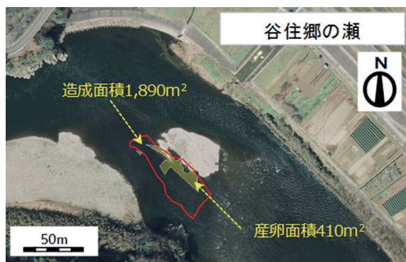
図13. 谷住郷の瀬における造成範囲とアユの産卵範囲（写真は島根県統合型 GIS による）
