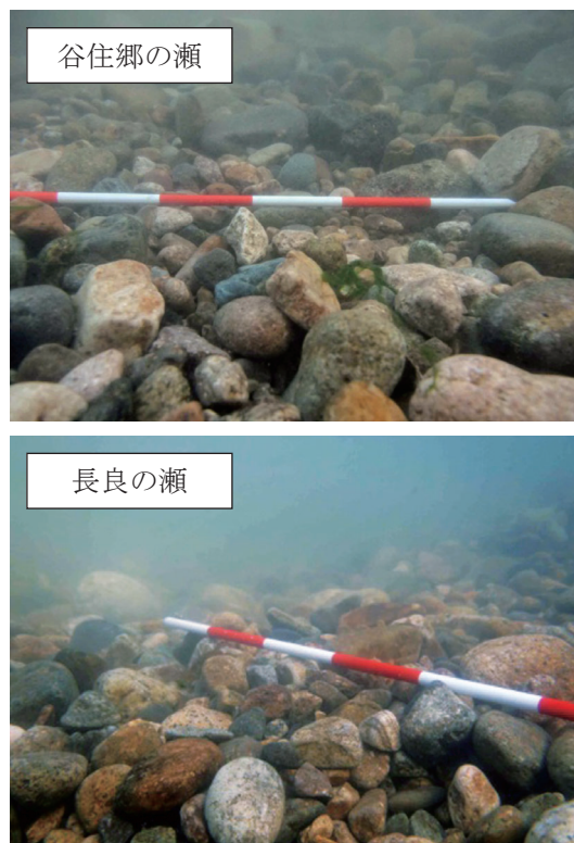
図12. 造成直後（2012年10月8日）の河床の状態（ピンの1目盛りは5cm）
