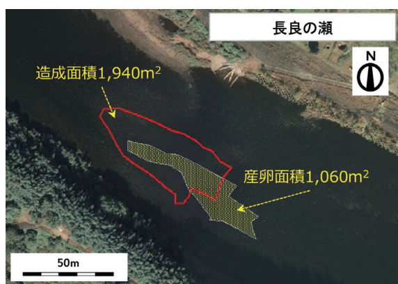
図14. 長良の瀬における造成範囲とアユの産卵範囲（写真は島根県統合型 GIS による）
