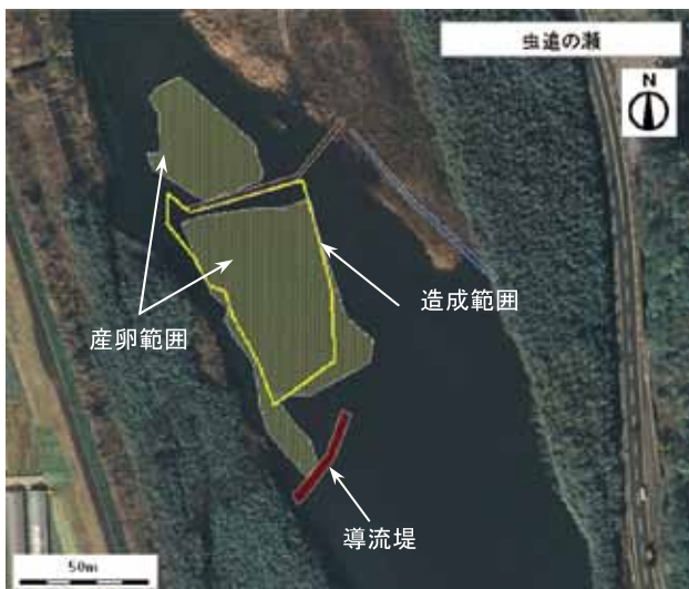
図15. 虫追の瀬の造成範囲と産卵範囲（黄色い太線で囲まれた部分が造成範囲, 黄色い網がけ部分が産卵範囲を示す）
