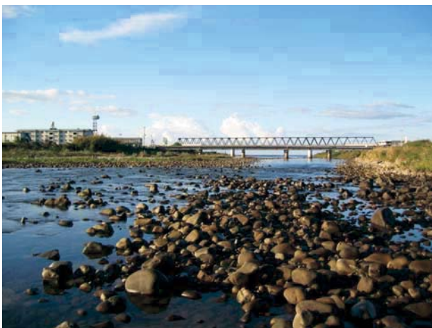
図2. 上流のダムで土砂が止められるために下流部まで川底が粗粒化した川（高知県奈半利川）
