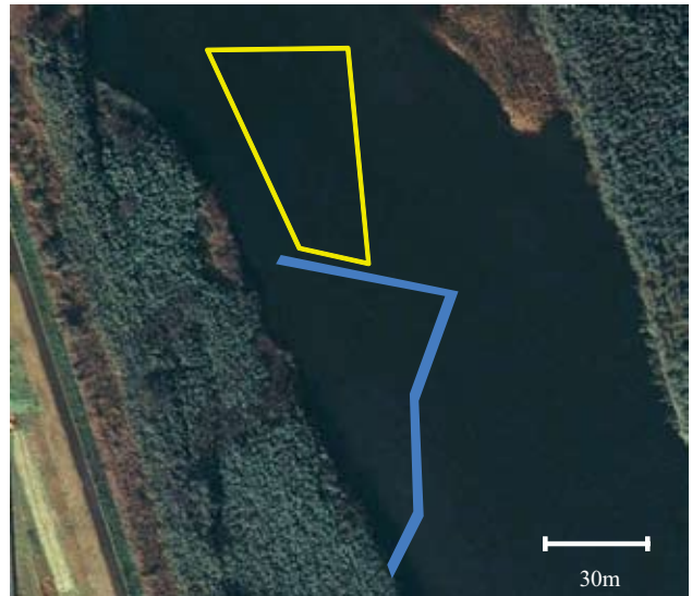
図10. 虫追の瀬の造成形状（黄色の線で囲まれた部分が造成部分、青い太線は築堤した導流堤）
