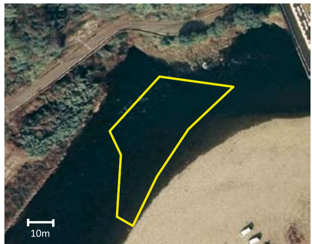
図11. バイパス上の瀬の造成形状（黄色の線で囲まれた部分が造成部分）
