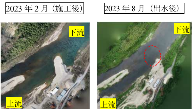
図2 2022年12月に施工した置き土の出水前後の状態 (赤い点線で囲った部分は土砂が流出した箇所)
