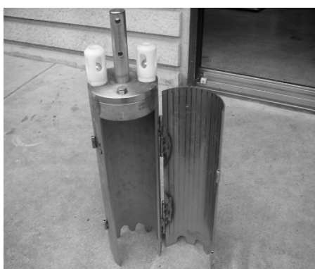
図2 コアサンプラー写真(左)と見取り図(右)
