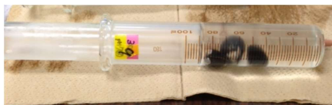
図4 硫化水素耐性試験の様子
