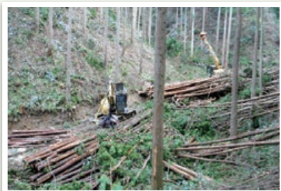
間伐木をスイングヤードにより集材。ハーベスタによる造材作業により間伐材を生産(間伐作業)
