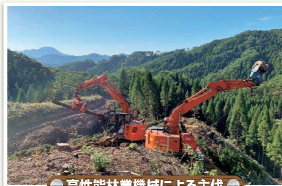
高性能林業機械による主伐
