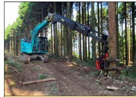
ロングリーチ伐倒ソーによる伐倒作業
