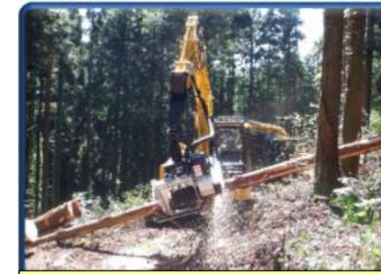
プロセッサによる枝払・玉切作業
