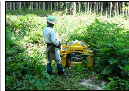
ラジコン式下刈り機による作業
