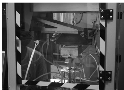
写真① コーンカロリメータ試験による10分間の総発熱量の測定
