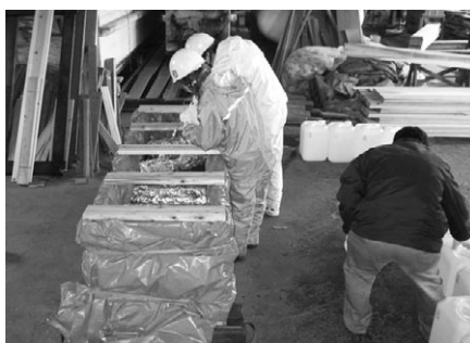
写真② 実大スギひき板への準不燃用液体の注入作業
