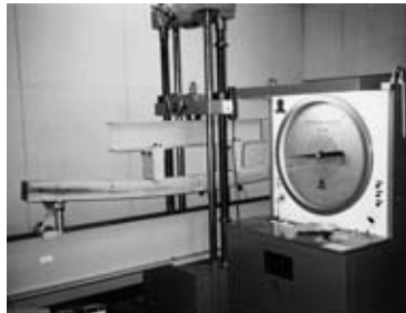
正角材の実大曲げ試験
