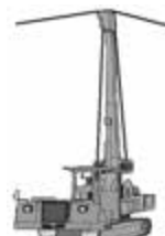
③タワーヤーダ (架線集材装置)
