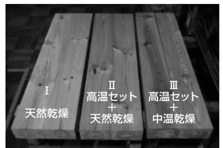
写真2 仕上げ加工したクロマツ梁材
