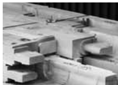
プレカット加工には高い寸法精度が必要
