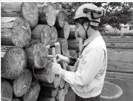
はい積み丸太のヤング係数測定試験
