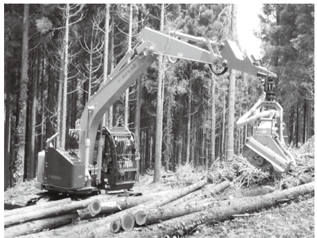
立木の伐倒、枝払い、玉切りを1台で行う高性能林業機械
