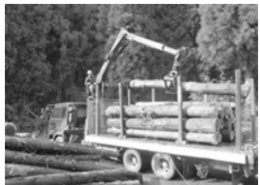
〔大型機械搬入による集材、運搬〕
