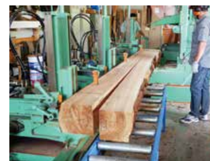
スギ大径材からの心去り材の製材
