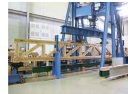
トラス梁の曲げ破壊試験
