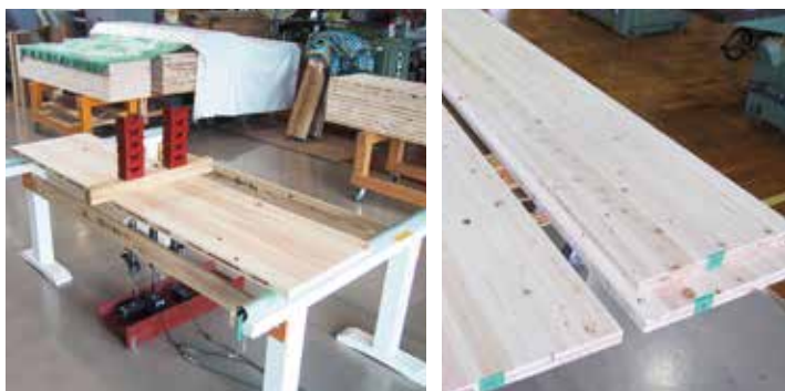
異樹種3層パネルの曲げ試験
