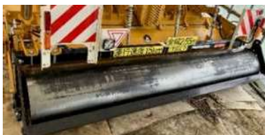
整地部分を改造した鉄ローラー
