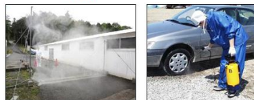
衛生管理区域入口の車両消毒装置
