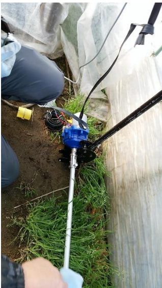
自動巻き上げ機動力部分
