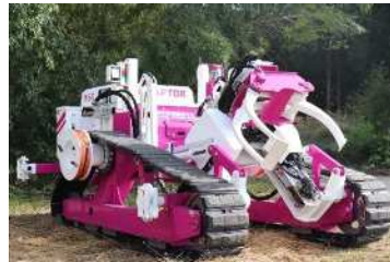
〈遠隔操作式伐倒機〉
