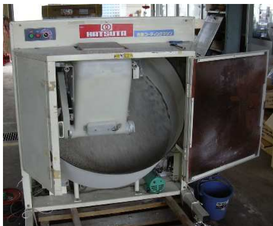
第 12-1 図 自動コーティングマシンによるコーティング作業
