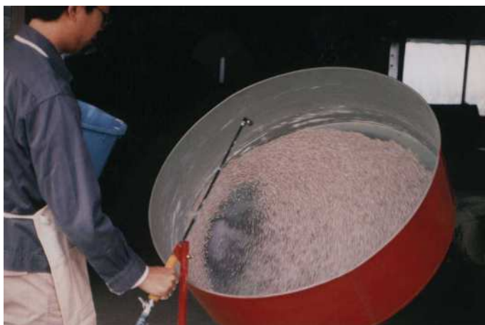
第 12-2 図 コーティングマシンによるコーティング作業
